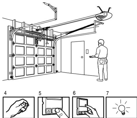
Нажать на оранжевую кнопку обучения, находящуюся на приводе, и держать ее до тех пор, пока не погаснет подсветка индикации обучения (около 6 сек). Таким образом, будут погашены все ранее запомненные коды. Каждое используемое Вами устройство радиуправления и каждая система доступа без ключа должны теперь программироваться заново.
