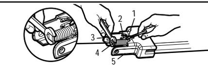
поворота гайки на 180 по часовой стрелке. **НЕ натягивать слишком сильно цепь/ зубчатый ремень.**
