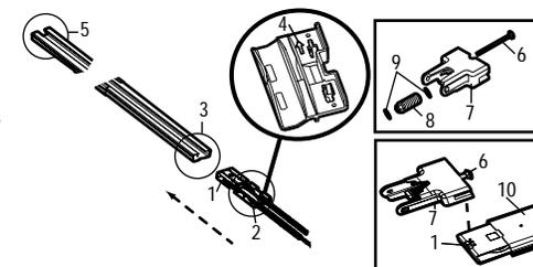
Продвинуть монтируемый элемент крепления (7) дальше вплоть до передней стороны рельса (10) (в направлении крепления архитрава).
