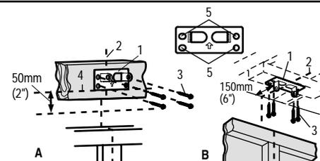
**А. Настенный монтаж:** Приложить крепление архитрава (1) к горизонтальной линии (2) посередине. При этом его нижний край должен совпасть с горизонтальной линией (4) (стрелка должна быть направлена к потолку). Наметьте отверстие (5) для крепления архитрава. Просверлите отверстия диаметром 4,5 мм и зафиксируйте крепление архитрава шурупами (3).
