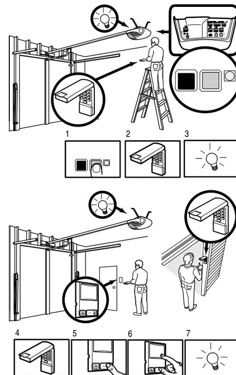
отпустите все кнопки. Таким образом, код будет запомнен. Если лампочка не установлена, то выдается два коротких звуковых сигнала.
