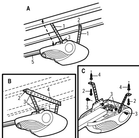
Поднимите привод и закрепите его на консоли подвесного крепления с помощью винта, стопорной шайбы и гайки (3). Убедитесь в том, что тавровый рельс расположен над воротами посередине. **УБЕРИТЕ** доску толщиной 25 мм и приведите ворота в движение руками. Если ворота натываются на рельс, установите крепление ходового рельса выше. Смажьте внутреннюю сторону рельса (5) густой смазкой.
